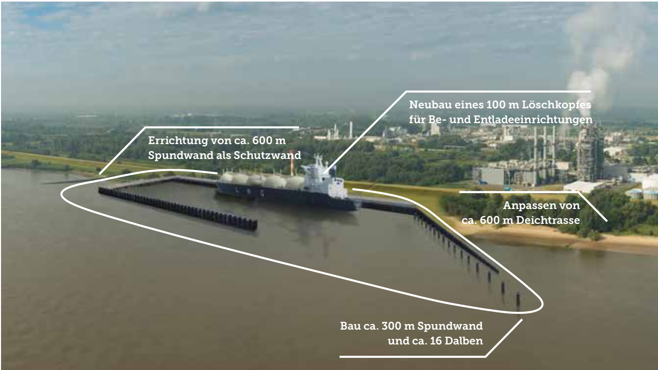
Planbereich 4: Anleger für verflüssigte Gase
